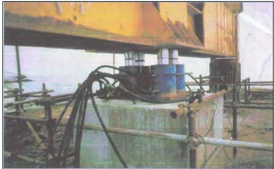
Foto n.2 - Martinetti idraulici per l'applicazione del carico e trasduttori di spostamento su palo in prova
